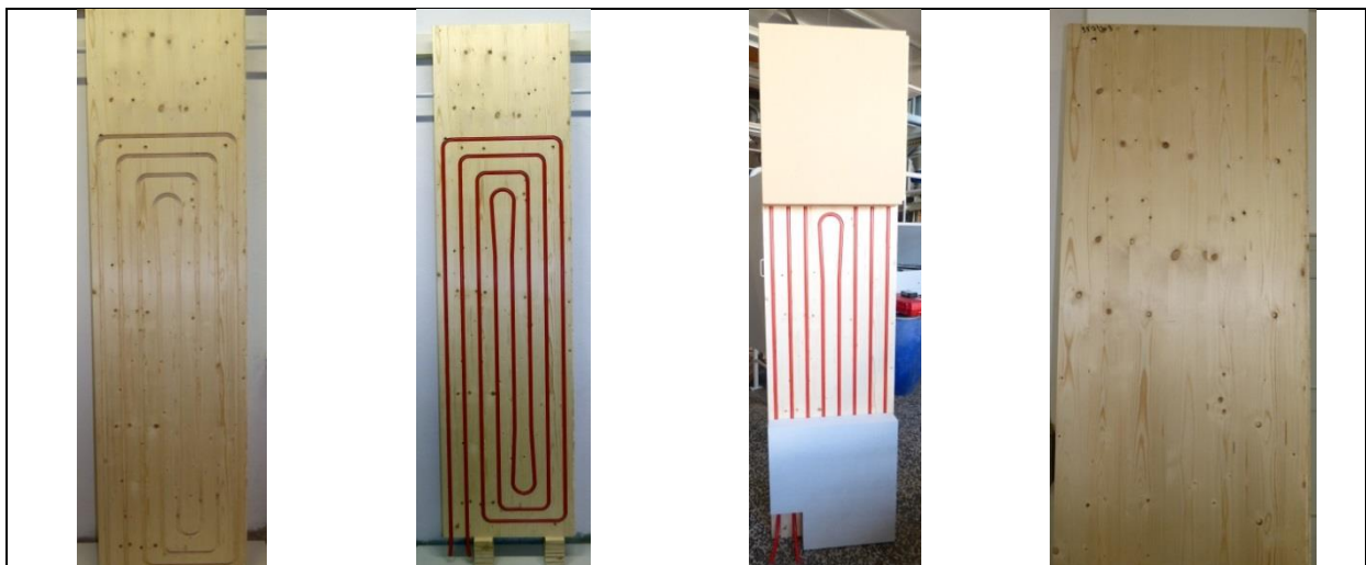
Abb. 2: Gefertigtes Element mit spiralförmiger Rohrverlegung, Größe 2,5 m x 0,62 m, Rohrabstand 8 cm, auf der wandzugewandten Seite mit aufgebrachter Dämmung und Ausschnitt in Mitte zur Darstellung der Verrohrung; (links: eingefräste Kanäle; 2. von links: mit eingelegten Rohren; 2. von rechts: fertiges Element mit Dämmung; rechts: raumzugewandte Seite)
