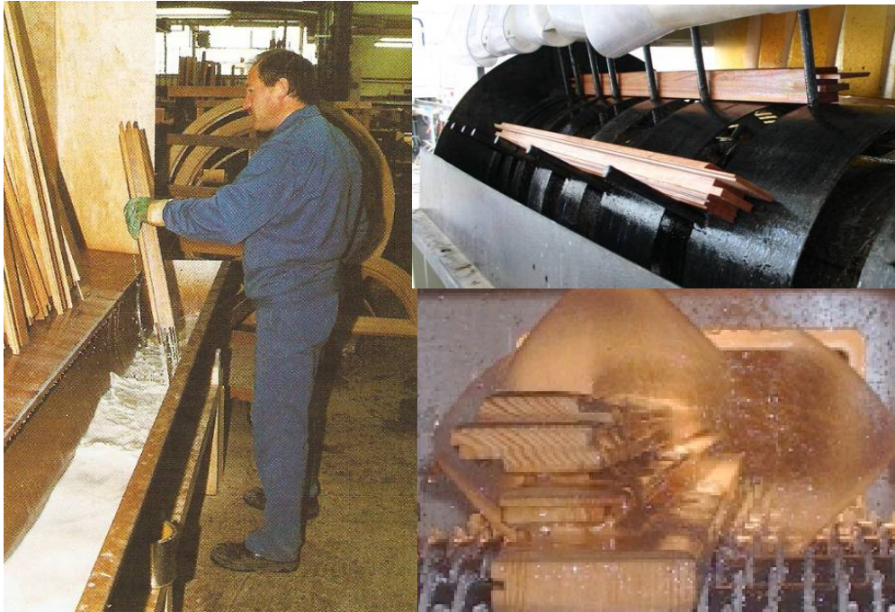
Abbildung 5: Chemischer Holzschutz am Einzelteil: Manuell (links) in einer Rotationstauchanlage (oben) sowie im Sprühtunnel (unten)
