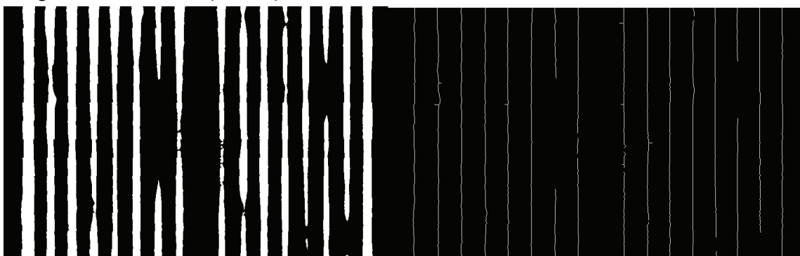
Abb. 4: Ausschnitt aus einem binären Thermographiebild (links), Ausschnitt skelettiert (rechts). Unterbrechungen in den vertikalen Linien (Leimfugen) deuten auf eine zu geringe Erwärmung hin.
