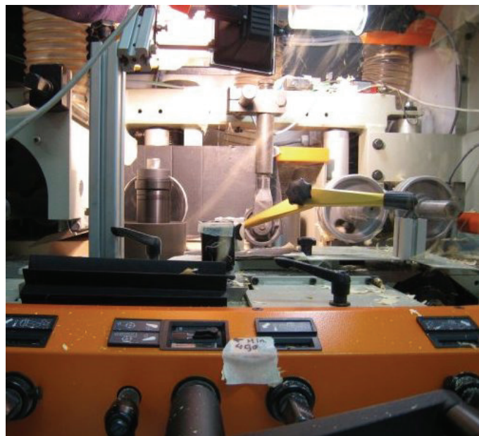
Abbildung 3: Versuchsstand mit Schraubfräser und nach oben gerichteten Späneauswurf
