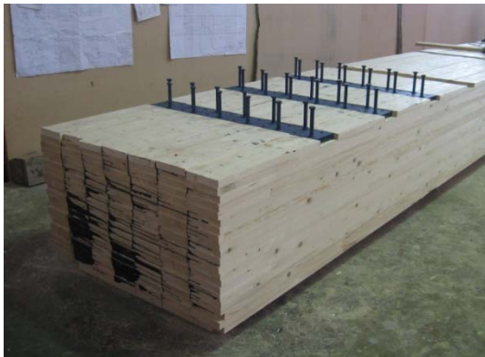
Abb. 1: Blockverleimter Brettschichtholzträger mit Verbundelement Dübelleiste (Pilotprojekt Birkbergbrücke Wippra)
