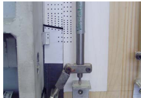
Abb. 5: Versagen infolge Abscheren des Vorholzes, appliziertes Photogrammetrie-Messfeld
