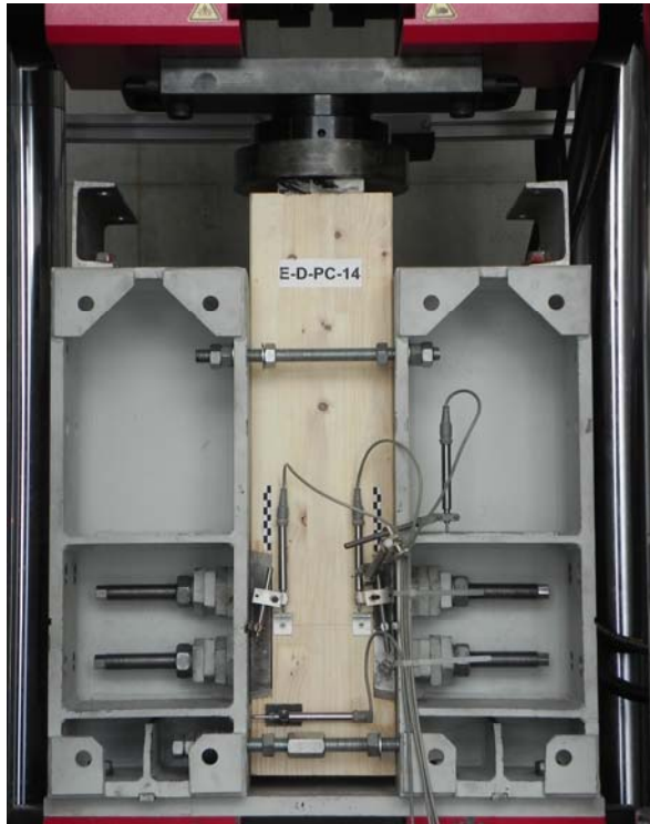
Abb. 4: Versuchsaufbau mit Messequipment für die Kurzzeit- und Ermüdungsversuche
