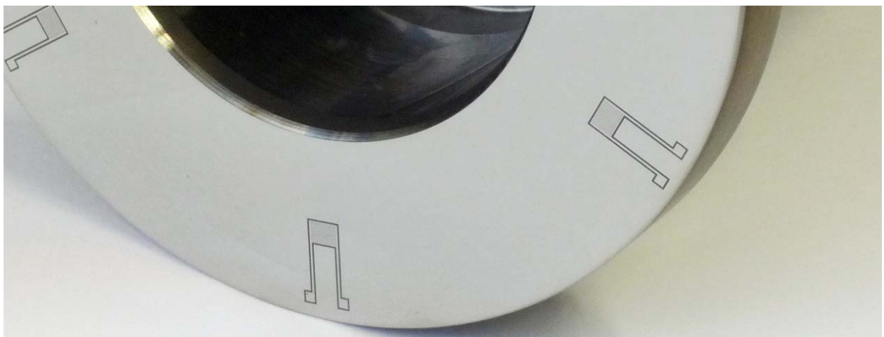
Bild 1: Elektrodenstruktur auf der Stirnfläche der Spindelwelle
