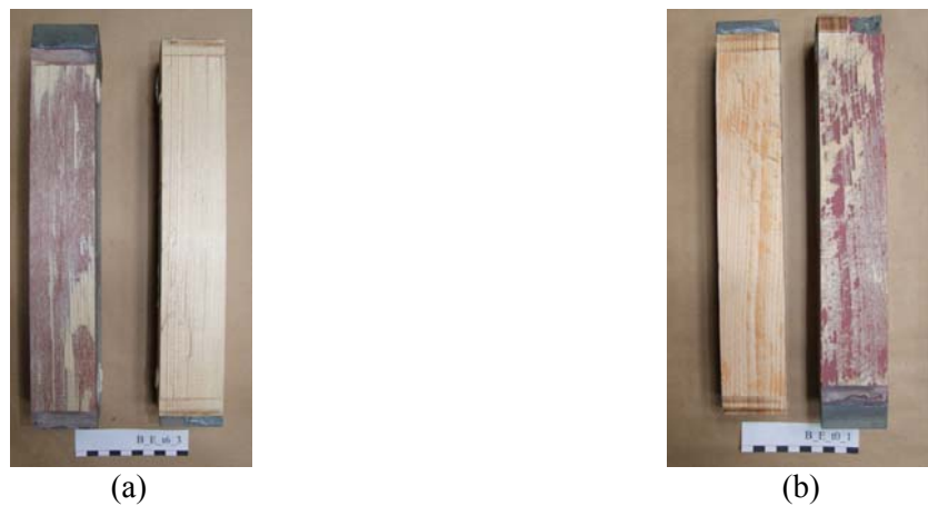
Abb. 2.3: Typische Bruchbilder bei den Verbundproben (a) Versagen im Holz; (b) Kombination von Holzversagen und kohäsivem Versagen im Klebstoff
