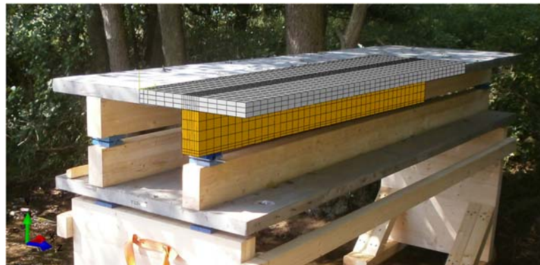
Abb. 3.3: Finite-Elemente-Netz für die numerischen Berechnungen im Vergleich zur Bauteilgeometrie
