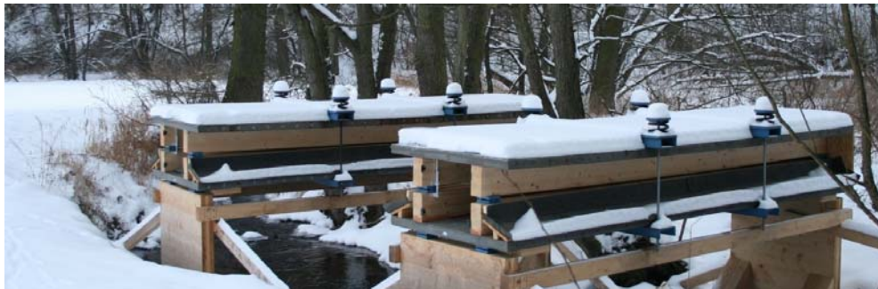
Abb. 2.5: Versuchsstand der Bauteile über einem Gewässer im Winter 2012 - 2013
