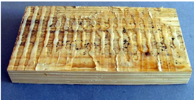
Abb. 1: Fehlverklebung bei einem mittels Vakuumverpressung verklebten Fichten-Brettsperrholz-Element. Als Klebstoff wurde ein feuchtevernetzender Einkomponenten-(1K-PUR-) Klebstoff verwendet.
