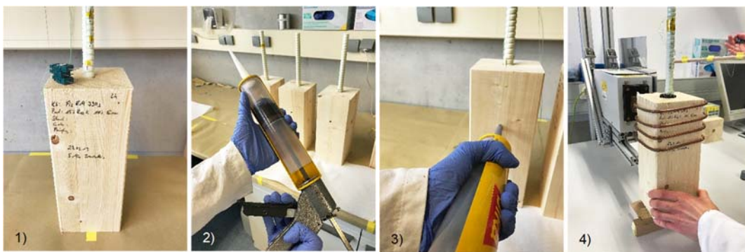
Abbildung 7: Herstellungsprozess eingeklebter GFK-Stangen in Fichtenholz im großen Probenmaßstab, (1) Probekörper mit angebrachten Thermoelementen, (2) Klebstoff-Partikelgemisch in Einwegkartusche, (3) Applikation Klebstoff-Partikelgemisch über Zuführbohrung, (4) Platzierung eines Probekörpers in der Induktionsspule
