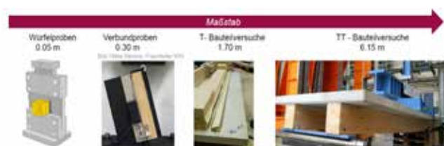
Abb. 3: Methodischer Ansatz für experimentelle Prüfkörper von kleinen Laborproben hin zu Proben im vollen Bauteilmaßstab. © Fraunhofer WKI, Univ. Kassel FBH, TU Braunschweig ifs
