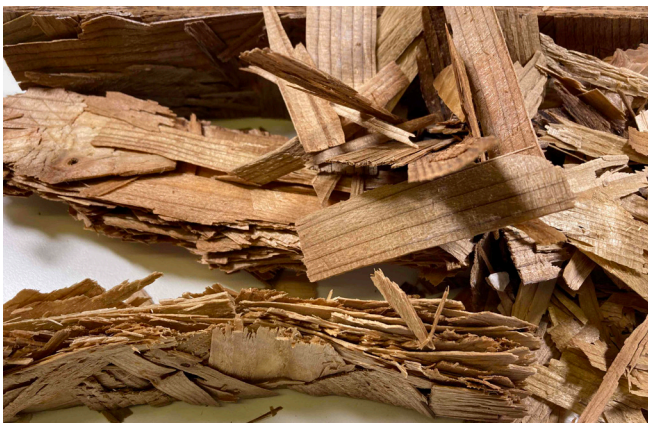
Abb. 3: Grobspäne mit mehr oder weniger aufgelöstem Recyclamine-Klebstoff, der die einzelnen Grobspäne für eine erneute Verwendung freigibt. © Peter Meinlschmidt
